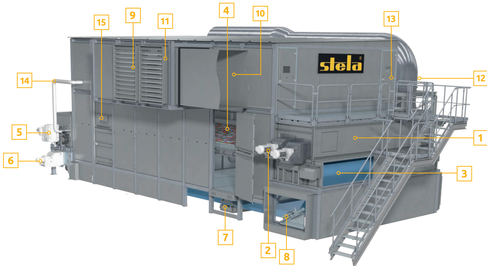
1 = 进料系统 | 2 = 双喂料螺旋 | 3 = 干燥网带 | 4 = 物料层 | 5 = 网带驱动 | 6 = 出料螺旋 | 7 = 网带水洗清洁系统 | 8 = 网带纠偏控制系统 9 = 进风口 | 10 = 热风口 | 11 = 全自动混气阀 | 12 = 排气风机 | 13 = 布风系统检修门 | 14 = 网带风洗清洁系统 | 15 = 翻料系统（可选）
